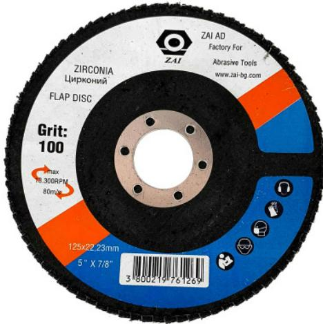
Ламелните дискове са абразивни инструменти, чиито компоненти са серия от абразивно покритие, поддържаща пластина и слепващ материал. Те са предназначени за използване в различни индустрии, тъглошлифанд и отстраняване на неравности от различни повърхности. Ламелите се делят на два типа: тип плоча и конусообразен тип. Поддържащата (междинна) част се предлага във вид на фибростъкло с висока плътност или гъвкава пластмасова плоча.
